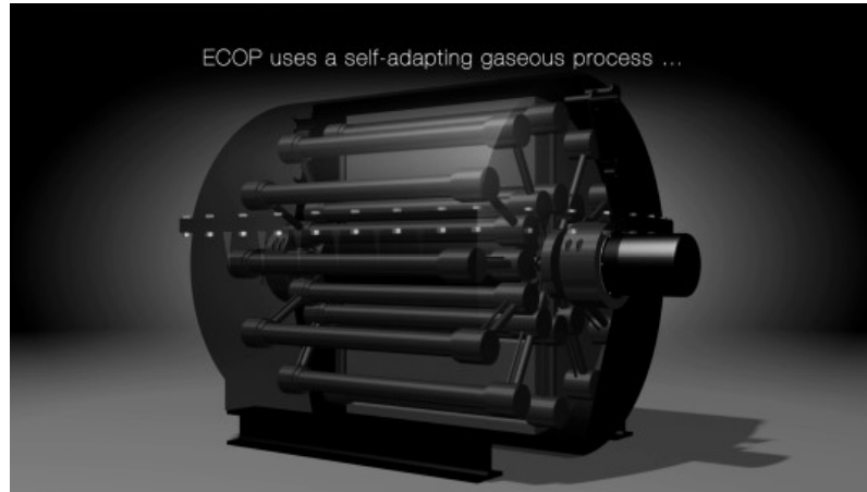
Wärmetauscher, paarweise angeordnet
