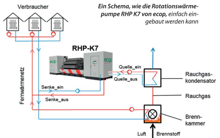
eine umweltfreundliche Umsetzung zu gewährleisten. Die ecop Rotationswärmepumpe (englisch „Rotation Heat Pump – RHP“) verwendet dazu eine Mischung aus Edelgasen, deren GWP gleich null ist und die weder entflammbar noch toxisch sind. Möglich wird dies dadurch, dass sie einen anderen physikalischen Prozess (Joule-Prozess) verwendet als konventionelle Wärmepumpen.
