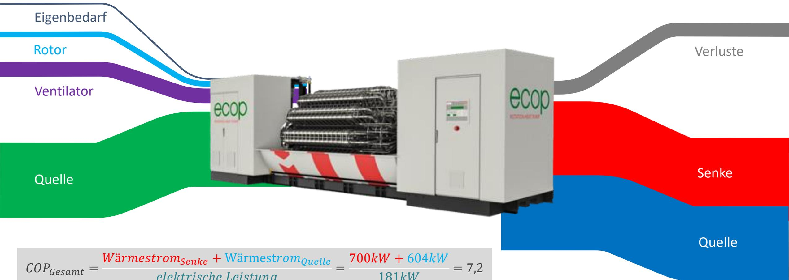
$$COP_{Gesamt} = \frac{\text{Wärmestrom}_{Senke} + \text{Wärmestrom}_{Quelle}}{\text{elektrische Leistung}} = \frac{700kW + 604kW}{181kW} = 7,2$$
